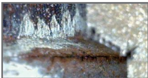
冷却穴段付き部のサビ及びクラック
