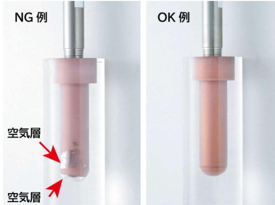
SUSブッシュ組込時に充填剤がしっかり充填されておらず空気層ができてしまっている状態。空気層が断熱してしまい、冷却水を流しても冷却されない状態になってしまっている。
