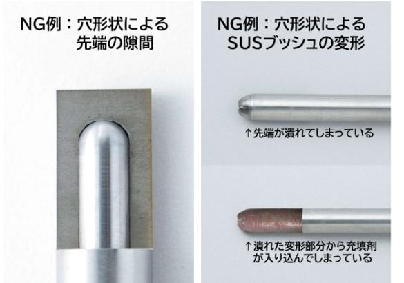
金型側の穴の先端に隙間ができてしまっている状態。金型側の穴の先端がSRになっておらず無理やりSUSブッシュを挿入したために、SUSブッシュが変形してしまった例。金型側の冷却穴の先端は必ずSRにする。
