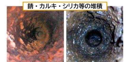
錆・カルキ・シリカ等の堆積により冷却穴内部が狭く冷却水の流れも悪くなり冷却効果が落ちてしまっている状態。SUSブッシュ化することで錆等の発生を緩和し冷却性能の降下を防ぎます。
